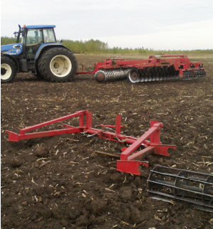
3. kép: A kötött talajon szétszakadt munkagép.
